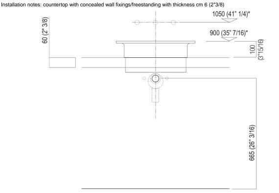
Scarico per sifone ad incasso e piletta con canotto fisso Drain for concealed waste trap with not adjustable pipe
